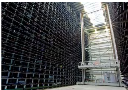
Aus den zwei Regalblöcken des 20 Meter hohen Kassettenlagers können die Waren automatisch zu den Mitarbeitern transportiert werden.
